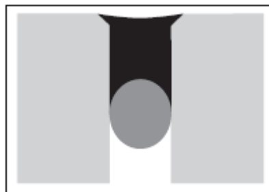
Een volvlak voegontwerp sluit stuikelgevaar en vuilophoping uit.
